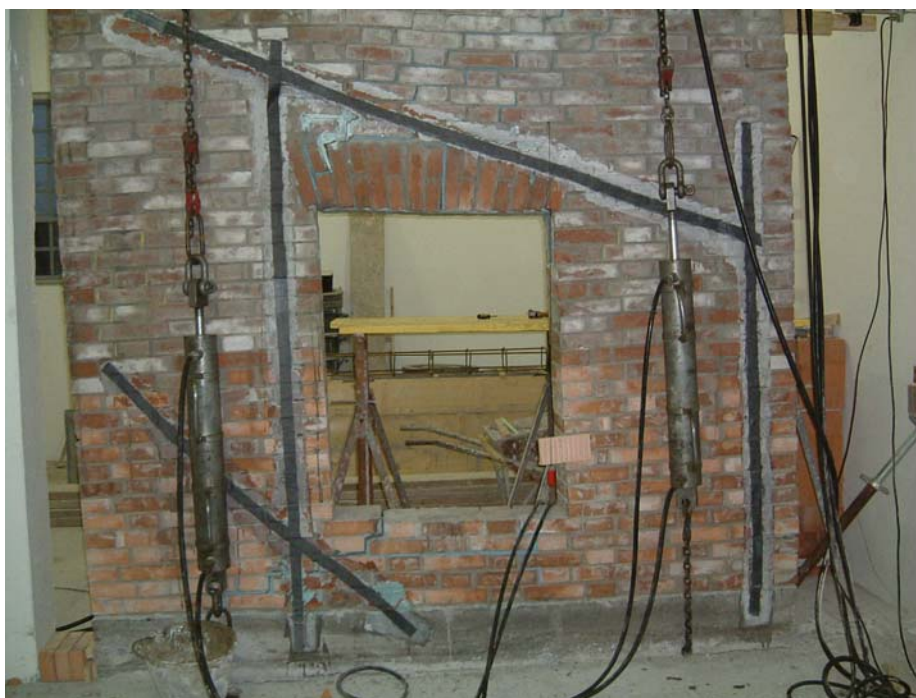
Pareti in muratura sottoposte ad azioni solo nel piano: forze verticali costanti e forze orizzontali crescenti sino al collasso. Prove eseguite sulle pareti prima in condizione naturale poi in condizione rinforzata in composito (nastri in CFRP).
